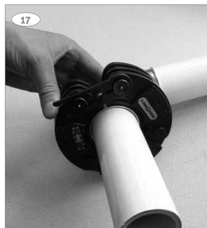
14: Aseta puristuskaulus PressCheck®-puristusrenkaaseen.
