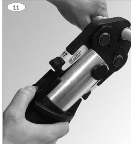
11 + 12: Käynnistä puristuslaite käynnistuspainikkeella ja irrota laite, kun olet puristanut liittimen.
